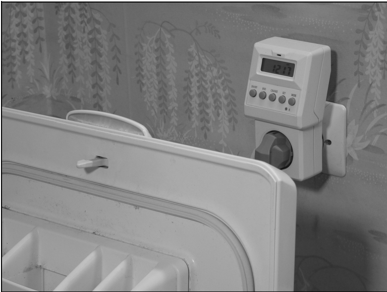
Figure 2 - Une cafetière de 800 W alimentée en 230 V est traversée par un courant de 3,47 A ( I = P / U ). Nous avons effectué cette mesure avec le programmateur/compteur d'énergie de la photo (raccordé ici à un lave-linge). La tension et la puissance sont deux paramètres fixes : la tension est imposée par le secteur, la puissance par l'appareil électrique. (Photo : Scheimpflug)
